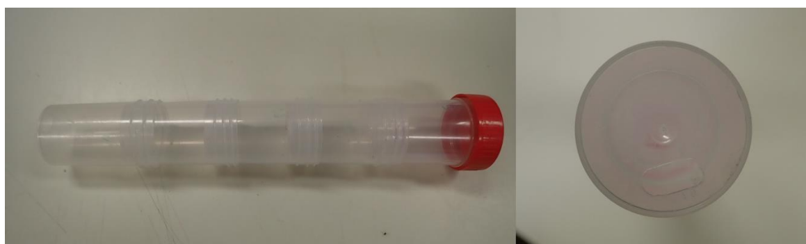
Figure 1 : Tunnel de test pour insecte. Nous avons testé les insectes dans un tunnel avec des parois percées successivement par des trous de plus en plus petits. Les trous testés sont de type fente, allongés avec une largeur qui diminue au fur et à mesure de l'avancée dans le tunnel.
